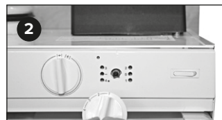
Nupin alla on säätö- ja mittausreiät
