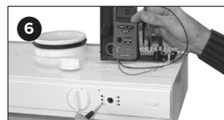
Voit tehdä mittauksen myös liitinrimalta, sähkökaavion osoittamista paikoista.
