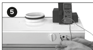
Mittaa jännite navoista – ja S, säädä nopeus 2 potentiometrillä 2, jne.
